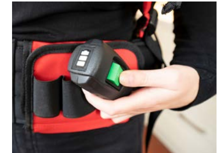
Ein-/Ausschalter mit Batterieanzeige
